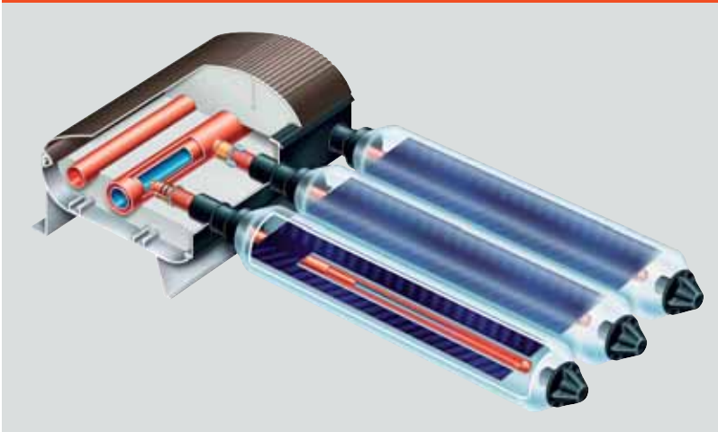
Przekrój kolektora próżniowego z przepływem bezpośrednim
