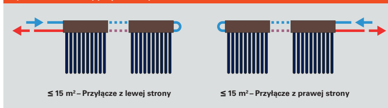
Rys. C.1.1-6 Warianty połączenia w pole kolektorów (Vitosol 300-T)
