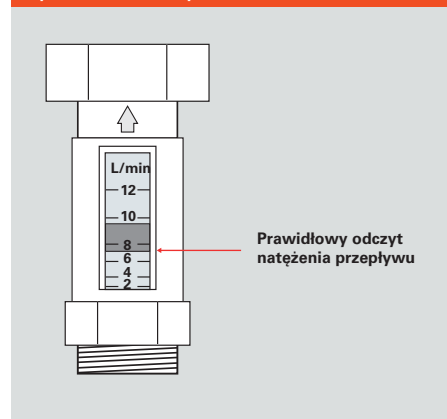
Rys. B.3.1–12 Odczyt wskazań na rotametrze
