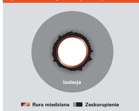
Rys. B.3.2–4 Izolacja ze strefą zeskorupienia
