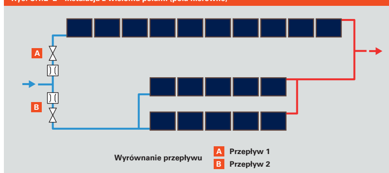
Rys. C.1.2-2 Instalacja z wieloma polami (pola nierówne)
