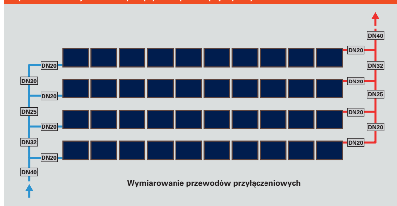
Rys. C.1.2-6 Projektowanie przepływu w polach pojedynczych
